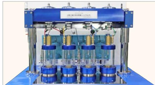
一度に4つの供試体を載荷しますので、1台で装置4台分のランニングコストをカバーでき、また、試験時間も1/4に短縮できます。
