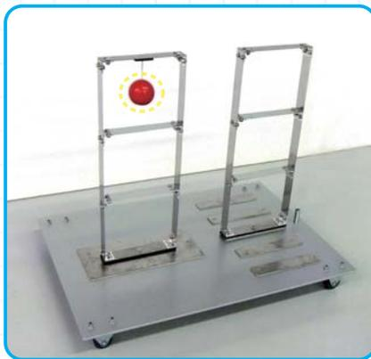
水槽やボールを用いることにより、振動エネルギーを吸収し揺れにくくなります。
